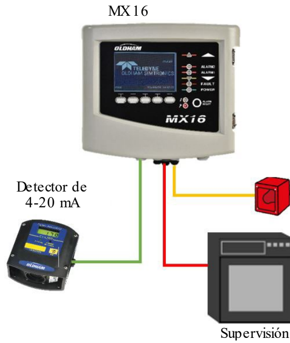
Imagen 2: Ejemplo de configuración del MX 16 con un detector analógico
